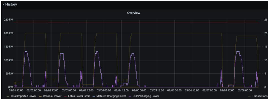
**Total Imported Power:** Die gemessene Leistung am Netzanschlusspunkt = EVU Messung. Die gesamte importierte Leistung muss immer unter dem LaMa-Grenzwert liegen.
